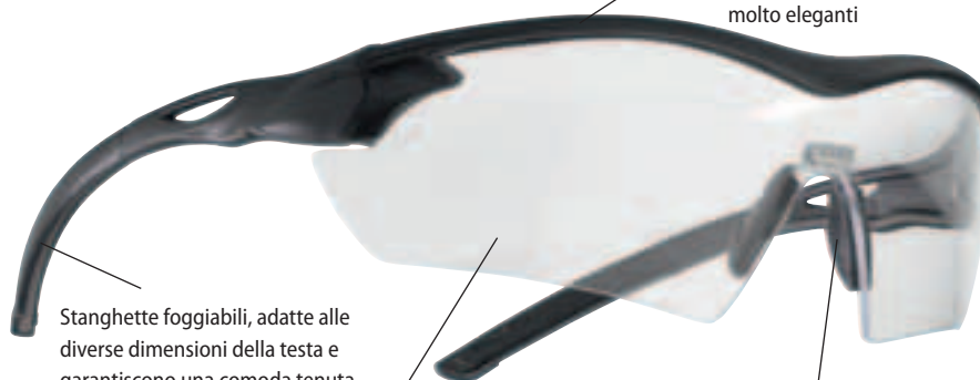
Monolente molto resistente all'impatto, conforme allo standard MIL-V-43511C clausola 3.5.10. e MIL-PRF-31013 clausola 3.5.1.1 (198 m/s)
